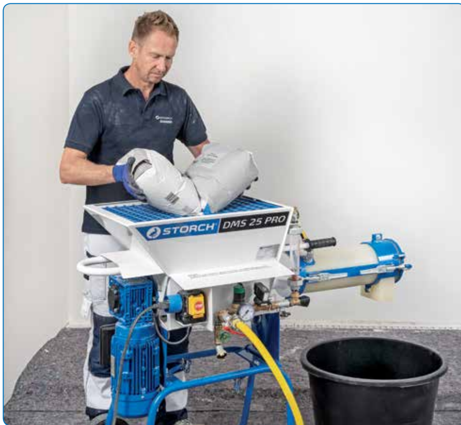
Getand beschermrooster om de zakken eenvoudig open te scheuren en snel leeg te maken.
